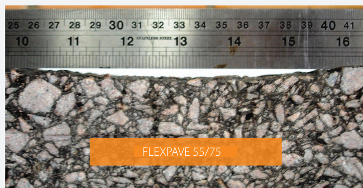
Figura 4: Foto da deformação permanente da mistura com FLEXPAVE 55/75.
