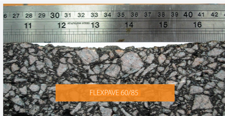
Figura 5: Foto da deformação permanente da mistura com FLEXPAVE 60/85.
