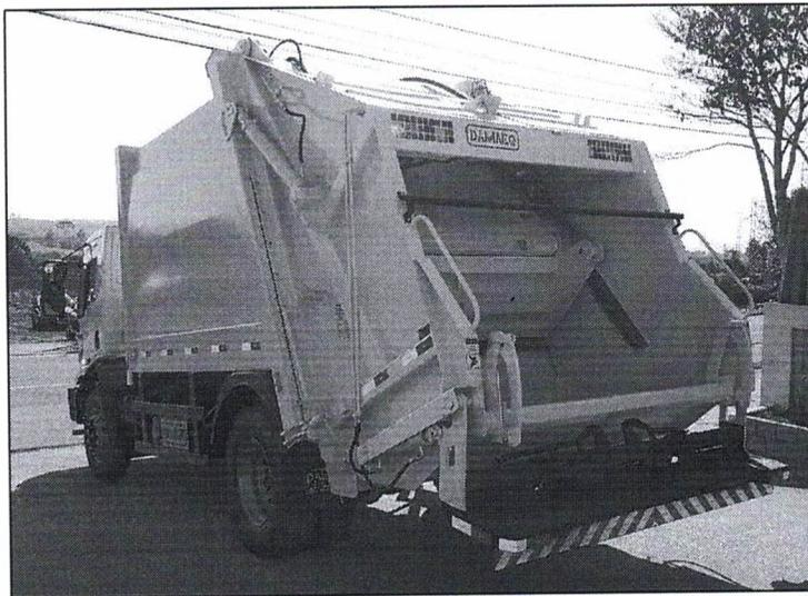
Coletor novo, de fabricação nacional, com capacidade para 15 m<sup>3</sup>, teto em chapa lisa, laterais em chapa única calandrada e lisa, descarga por painel ejetor, com cilindro de dupla ação e sistema de carregamento traseiro, com compactação por sistema de patim deslizante, com sapatas de UHMW, acionado por dois cilindros de compactação com diâmetro de 4 ½", e placa de transferência comandada também por dois cilindros com diâmetro de 4", e comando semiautomático;
