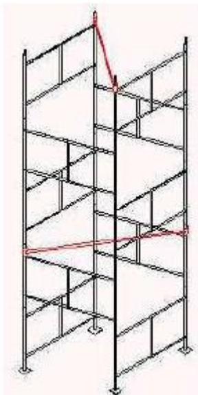
Figura 19 - Andaimos Interno Tubulares Simples - Tipo Torre
