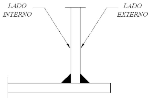
Figura 7 - Junta do Fundo com Costado
