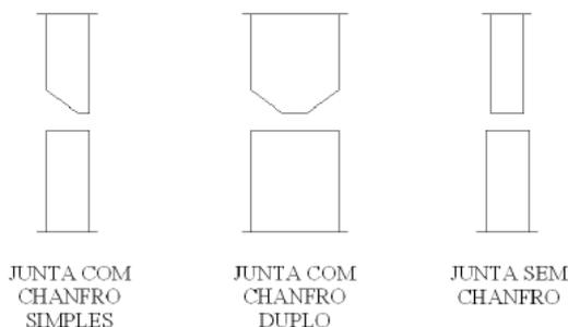
Figura 15 - Juntas Horizontais Típicas de Costado
