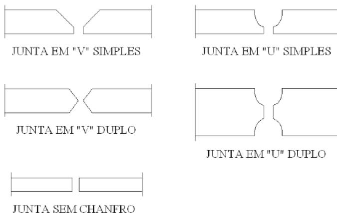
Figura 14 - Juntas Verticais Típicas do Costado
