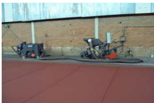
Figura 4 - Máquina de Jato a Granalha de Aço
