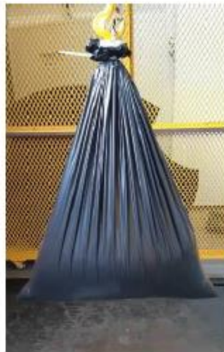
Figura 3. Ensaio de Resistência ao Levantamento.
