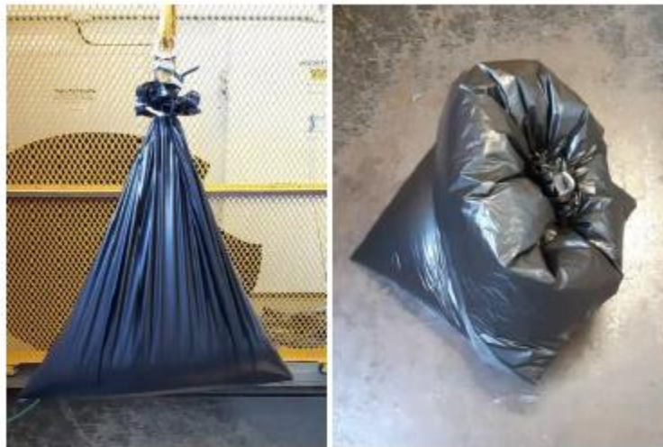
Figura 4. Ensaio de Resistência à Queda Livre.
