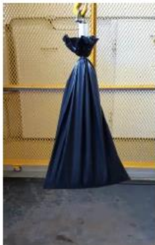
Figura 5. Ensaio de Verificação da Estanqueidade.
