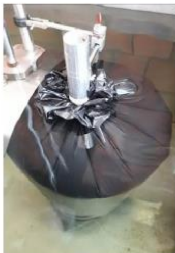
Figura 7. Ensaio de Determinação da Capacidade Volumétrica.
