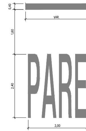
DETALHE "3" LEGENDA "PARE", "DÊ A PREFERÊNCIA" E LINHA DE RETENÇÃO PINTURA BRANCA - TERMOPLÁSTICO HOT SPRAY
