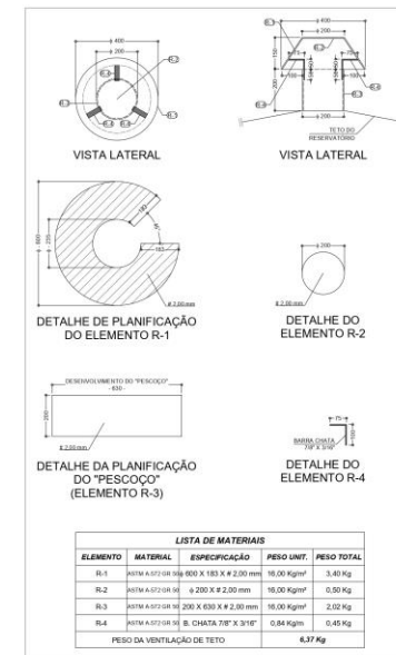
DETALHE DA VENTILAÇÃO DE TETO ESCALA 1:10
