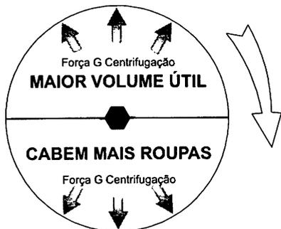
Força centrífuga diretamente na chapa, distribuída uniformemente em uma superfície cilíndrica, sem emendas ou soldas, não rasgando as roupas, e não causando desbalanceamento.
