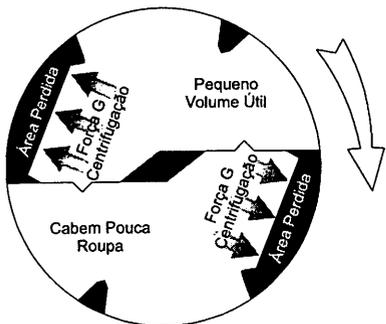
Força centrífuga diretamente na porta, superfície reta, podendo ocasionar ruptura, trincos, desbalanceamento, rasgo nas roupas; etc.
